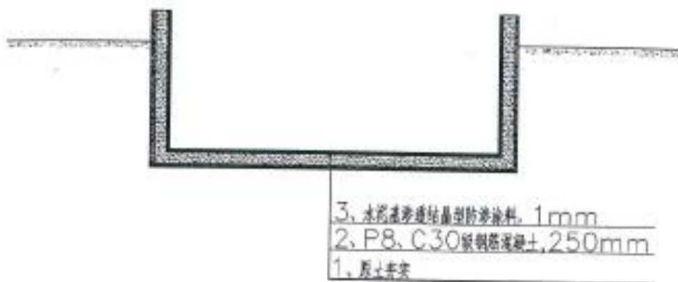
图 7.5-3 废水装置池体防渗结构示意图
